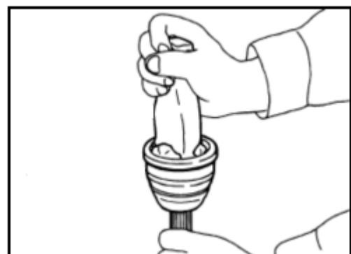
11 用胶带裹住花键后，将新的防尘罩安装在驱动轴上并紧固小端卡箍，避免损坏防尘罩。
